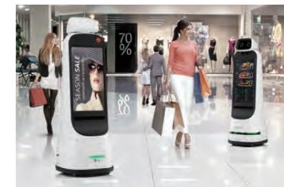
2018年から仁川空港で運用されている第1世代モデルは、3年間で3,000km以上を走行し、その高い技術力と使いやすさを実証しました。さらに、LG CLOiガイドロボットはエレベーターの安全認証と15個の下部センサーにより、低い障害物も高精度に認識し、自立的に動き回ります。また、施設情報や目的地までの地図を提供するスマートガイドとしての役割も果たします。
